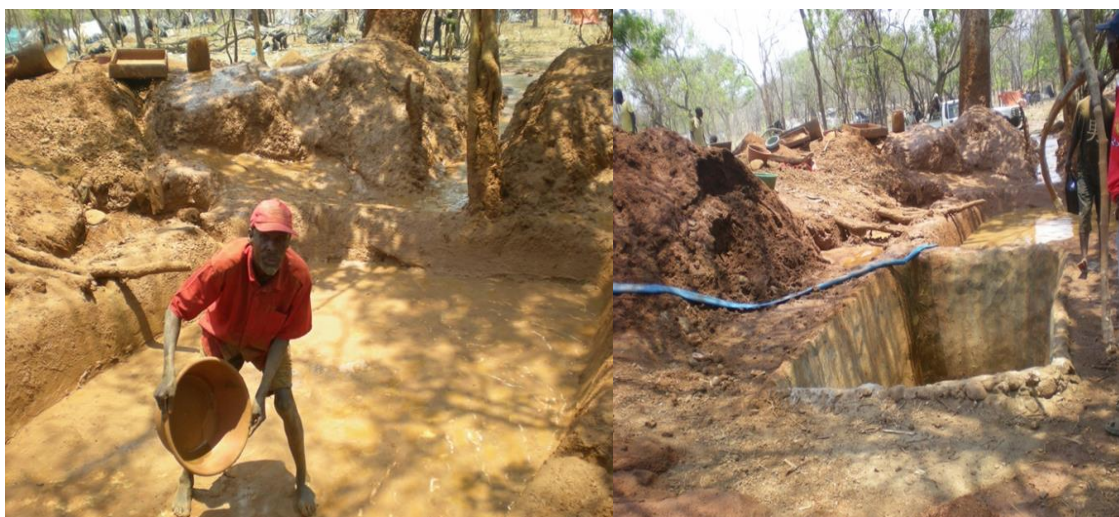
Figura 2: Bacias de decantação
