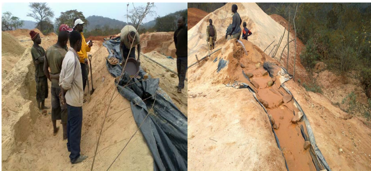
Figura 1: Técnica de Sluice
