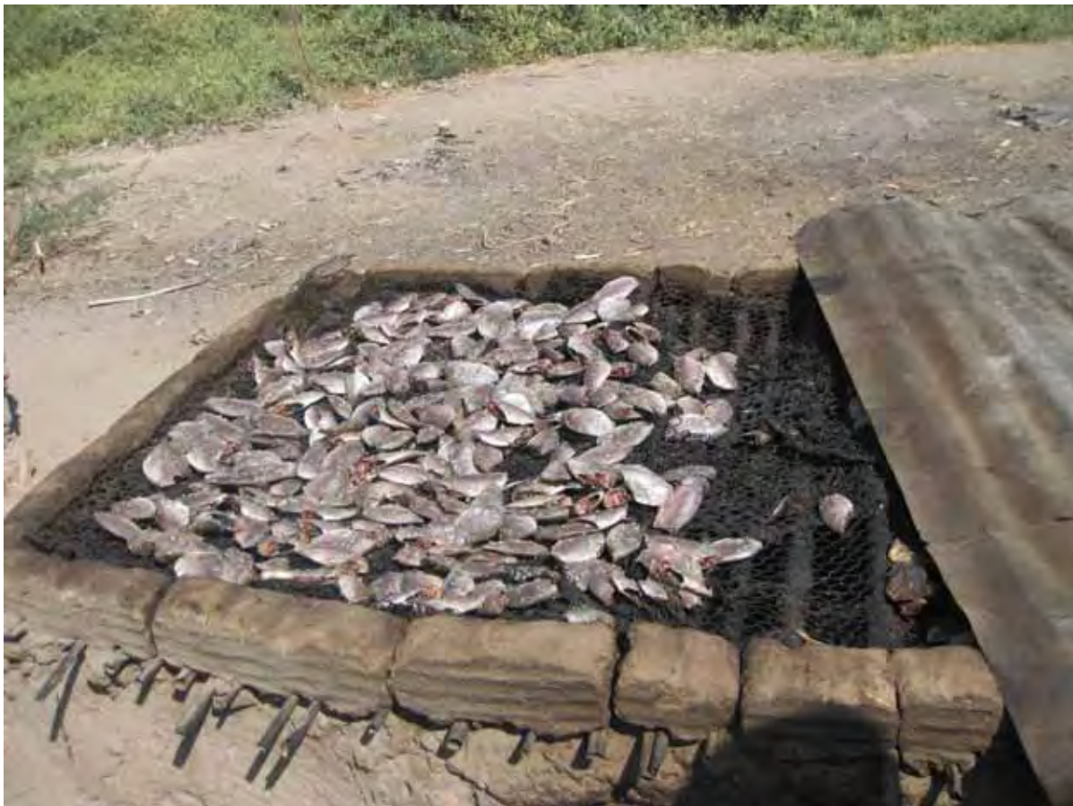
Fumage de la récente capture de petits poissons ; four en banco et grillage
